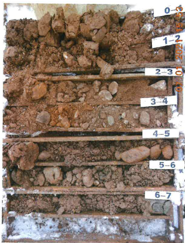
Obr. 3: Geologický profil vrtu ILB.
