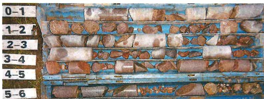
Obr. 8: Geologický profil vrtu V1 PB.
