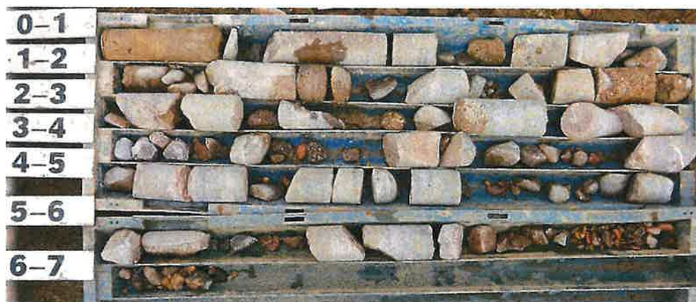
Obr. 7: Geologický profil vrtu V1 LB.
