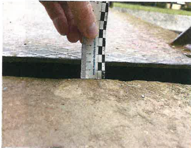
IMG_5440 - výškový rozdíl povrchu mostovky a opěry na začátku lávky je do 20mm
