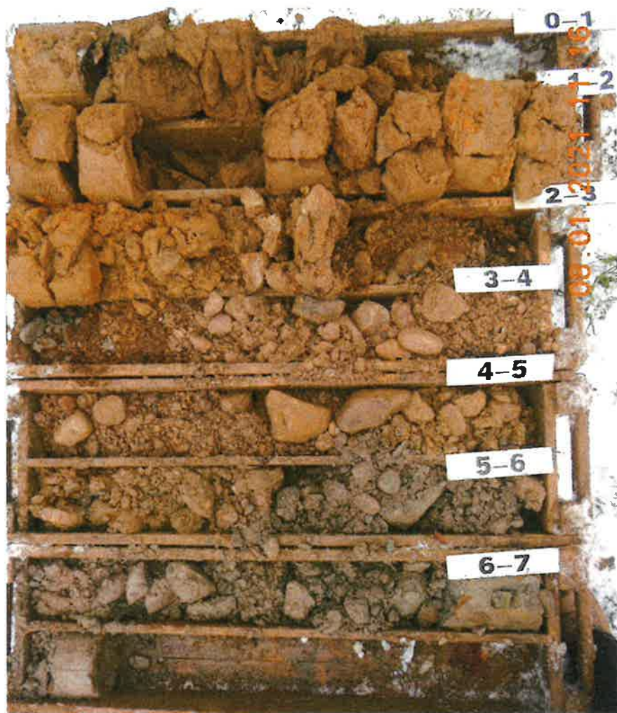
Obr. 4: Geologický profil vrtu IPB.
